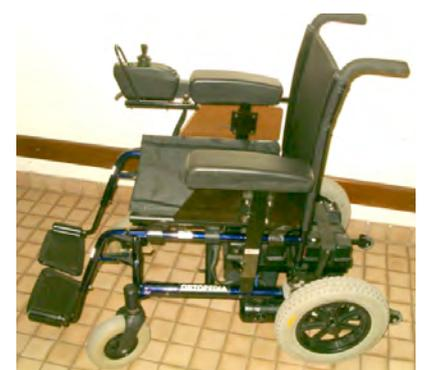
**Fauteuil roulant à propulsion par moteur électrique**
